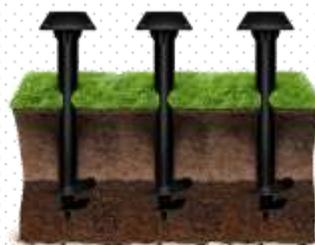
Винтовые сваи, применяемые в строительстве воздушных линий и контактной сети ржд:
